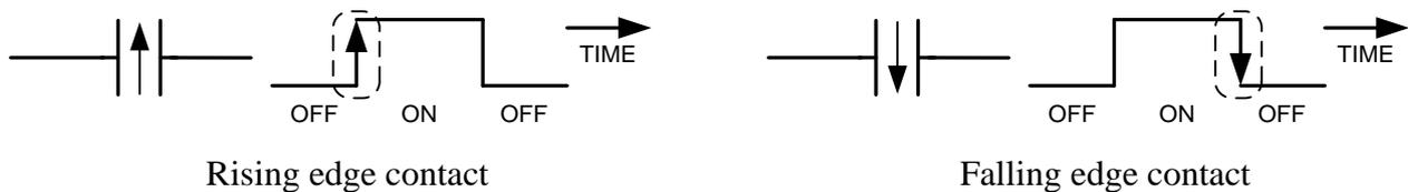
Fig. 18 – Edge filtering
